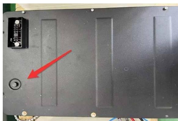
Figura 3. Válvula de alívio de pressão
